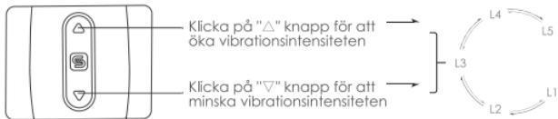
Klicka på "△" knapp för att öka vibrationsintensiteten
